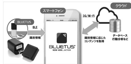
図1 ビーコンを利用するシステムの構成
